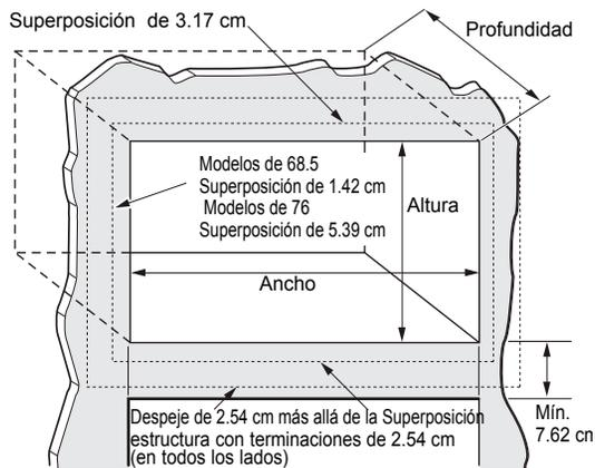
En modelos de 68.5 cm, deje 3.175 cm sobre la parte superior, 1.42cm a cada lado y 2.54 cm en la parte inferior para la superposición de la estructura ajustable sobre los extremos del recorte.
