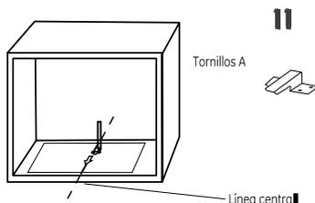
**3.** Retire el esquema del panel inferior del gabinete y sujete la abrazadera y el tornillo A.
