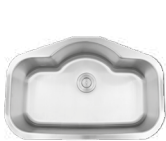
KUS3019A Tarja de Acero Inoxidable . Profundidad 220 mm. Contorno 770 x 490 mm. Calibre 18. Acabado Cepillado.
